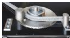
SystÈme de pliage avec tourillons et manchons pour tous les diamÈtres sur le tableau
