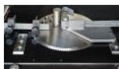
Système de pliage pour Étriers avec accessoires À la demande - pour fer diam. 10 mm, 16 mm, 20 mm
