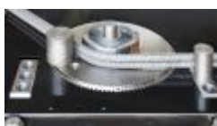
Système de pliage avec tourillons et manchons pour tous les diamÈtres sur le tableau
