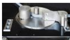
Système de pliage avec Équerre pour petit diamÈtres
